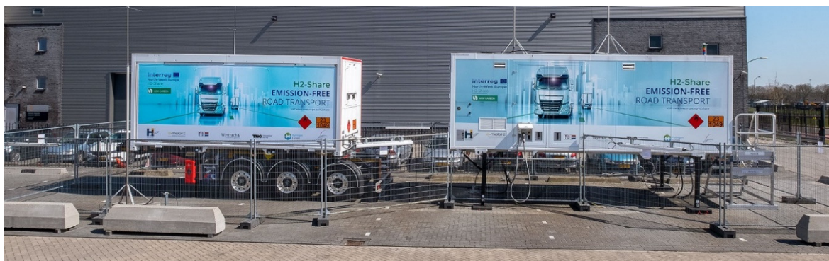
Obrázek 8: Mobilní plnicí stanice vodíku Wystrach (zdroj: Wystrach GmbH)
