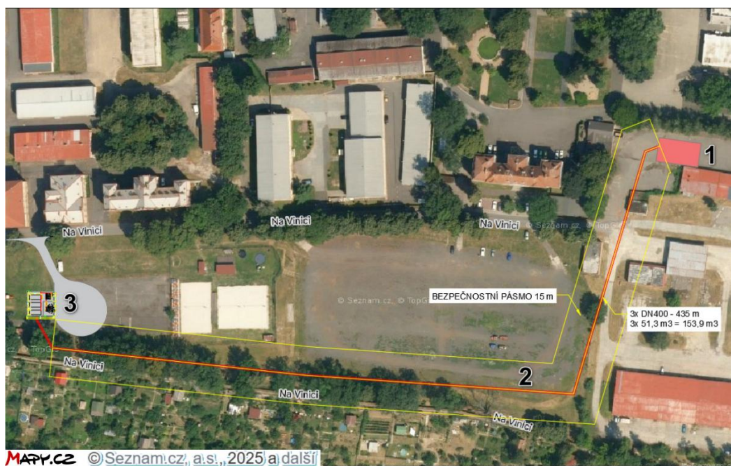
OBR. 1 – UKÁZKA MOŽNÉHO NÁVRHU UMÍSTĚNÍ TECHNOLOGIÍ VE VYBRANÉ LOKALITĚ, 1 – VÝROBA VODÍKU, 2 – PODZEMNÍ PROPOJ NÍZKOTLAKÝ, 3 – VODÍKOVÁ ČERPACÍ STANICE + VYSOKOTLAKÉ ÚLOŽIŠTĚ H_2
