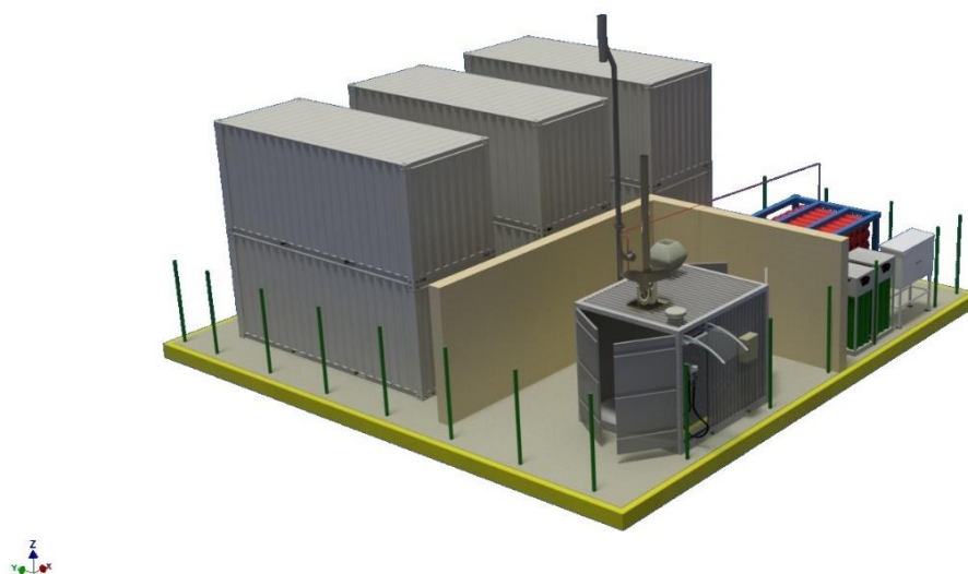
OBR. 4 – PŘÍKLAD MODELU KOMBINOVANÉ SESTAVY VODÍKOVÉ ČERPACÍ STANICE A VYSOKOTLAKÉHO ÚLOŽIŠTĚ
