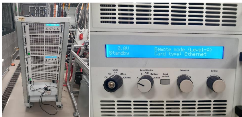
OBRÁZEK 13: SESTAVA SPŘAŽENÝCH ŘÍZENÝCH DC ZÁTĚŽÍ EA-EL 9400-150A
