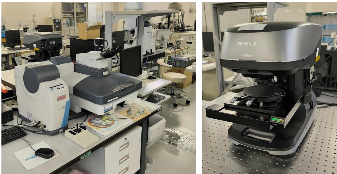
OBRÁZEK 6: LASER RAMAN MIKROSKOP (DXR2XI, THERMO FISHER SCIENTIFIC) A KONFOKÁLNÍ MIKROSKOP (VK-X, KEYENCE)
