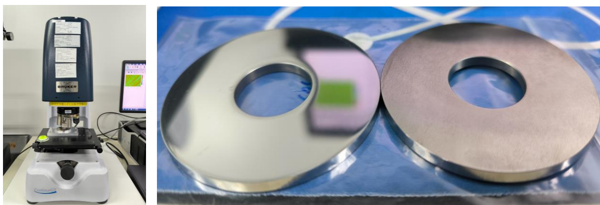
OBRÁZEK 1: 3D OPTICKÝ PROFILOMETR BRUKER, POROVNÁNÍ VZORKU PO LAPOVÁNÍ.
