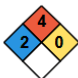
OBRÁZEK 3.17: OCHRANNÝ DIAMANT PODLE NORMY NFPA 704 PRO METAN [130].
