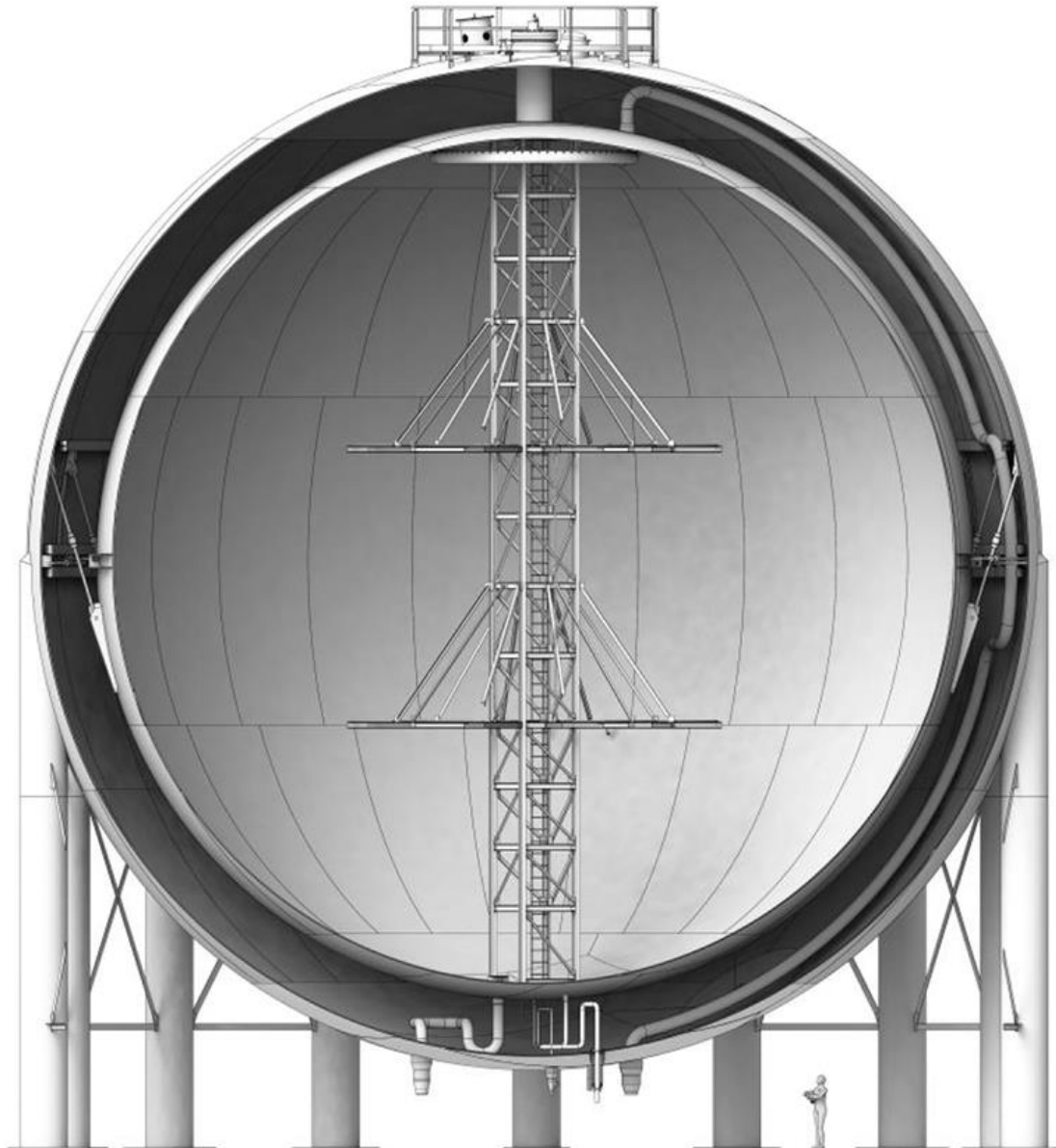
OBRÁZEK 6.1: ŘEZ VNITŘKEM SKLADOVACÍHO ZAŘÍZENÍ NA ZKAPALNĚNÝ VODÍK V KENNEDYHO VESMÍRNÉM STŘEDISKU, ZDROJ: NASA.
