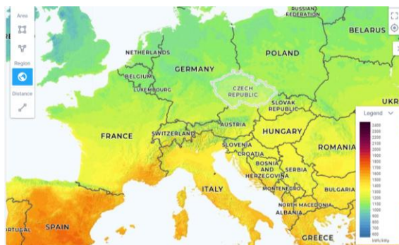
OBRÁZEK 6: VÝKON FOTOVOLTAICKÉ ELEKTRÁRNY V ZÁVISLOSTI NA SLUNEČNÍM SVITU
